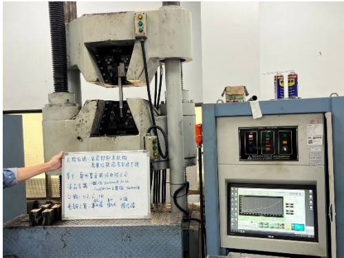
圖 4 鋼筋拉拔試驗
